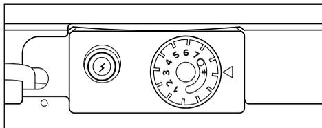
Appuyer à fond sur le bouton B, le maintenir enfoncé et appuyer simultanément sur l'allumeur piézoélectrique C. Vérifier, à travers le trou A si la flamme du brûleur s'allume. Après avoir vérifié que la flamme est allumée, maintenir appuyé le bouton B pendant 20 secondes environ. Si la flamme du brûleur pilote ne reste pas allumée, répéter l'opération décrite ci-dessus.
