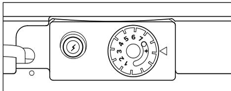
Presionar el selector B a fondo, mantenerlo presionado y simultáneamente pulsar el encendedor piezoeléctrico C.
