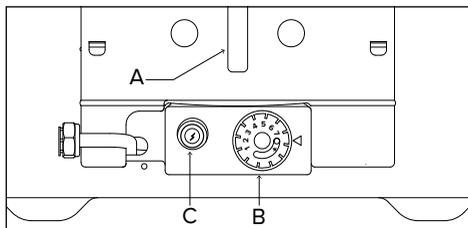
Tourner le bouton B de la position **O** (arrêt) sur la position **★** (pilote).
