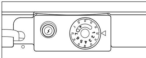
Para una mayor disponibilidad de agua caliente, se recomienda rodar el selector a la posición 5 y mezclar el agua para obtener la temperatura deseada.
