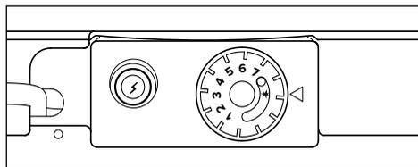
Premere la manopola B fino in fondo, mantenerla premuta e contemporaneamente premere l'accenditore piezoelettrico C. Verificare, tramite il foro A, se la fiamma del bruciatore è accesa. Una volta verificato che la fiamma è accesa mantenere premuta la manopola B per circa 20 secondi.
