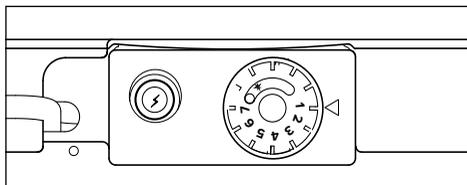
Pour obtenir une quantité d'eau chaude plus élevée, il est conseillé de laisser la manivelle en position "5" et de mélanger avec de l'eau froide afin d'obtenir la température désirée.
