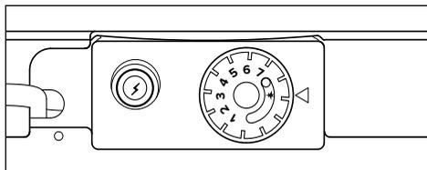
Druk de knop B helemaal in en houd deze ingedrukt; druk tegelijkertijd op de piezo-elektrische ontsteker C.
