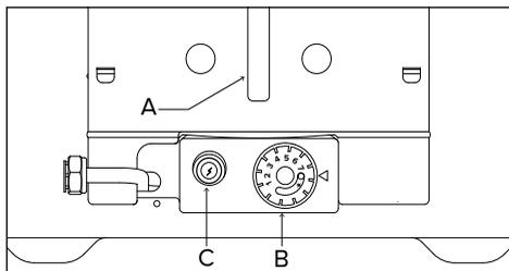
Draai de knop B van de stand **O** (UIT) naar de stand **★** (waakvlam).
